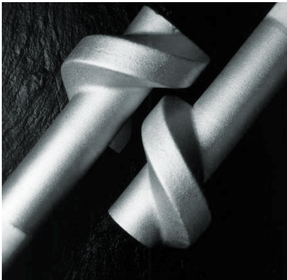
Mélangeurs en céramique recouverts de platine utilisés dans la fabrication du verre
